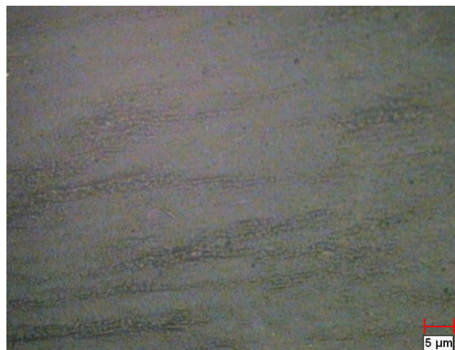
شکل ۷. ریز ساختار نوری نمونه آنیل شده در دمای 600^{\circ}\text{C} به مدت ۱۵ دقیقه.
