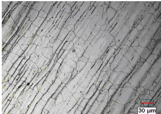
شکل ۱. ریز ساختار اولیه فولاد زنگ نزن ۳۱۶.
