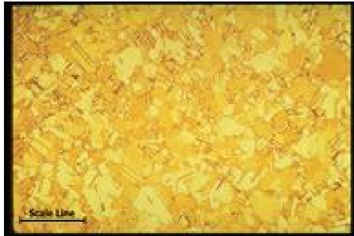
اندازه دانه ها: 0/055 mm مقیاس طولی خط: 500 میکرون
