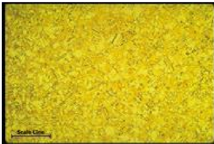
اندازه دانه ها: 0/035 mm مقیاس طولی خط: 600 میکرون
