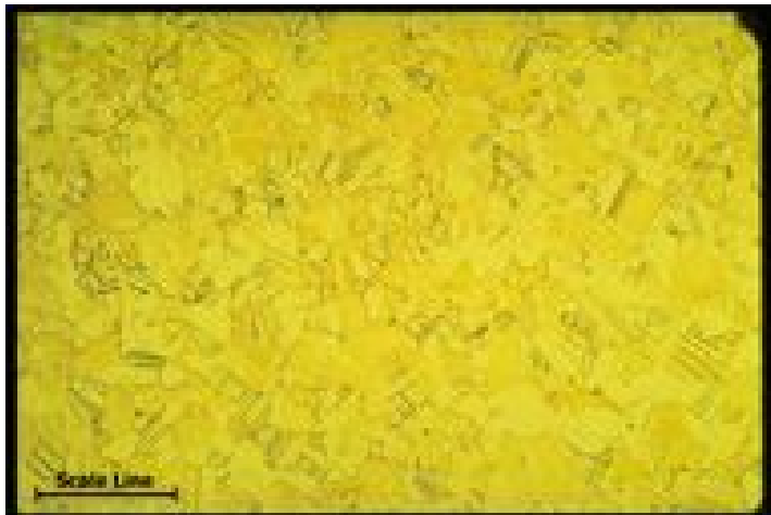
اندازه دانه ها: 0/09 mm مقیاس طولی خط: 600 میکرون
